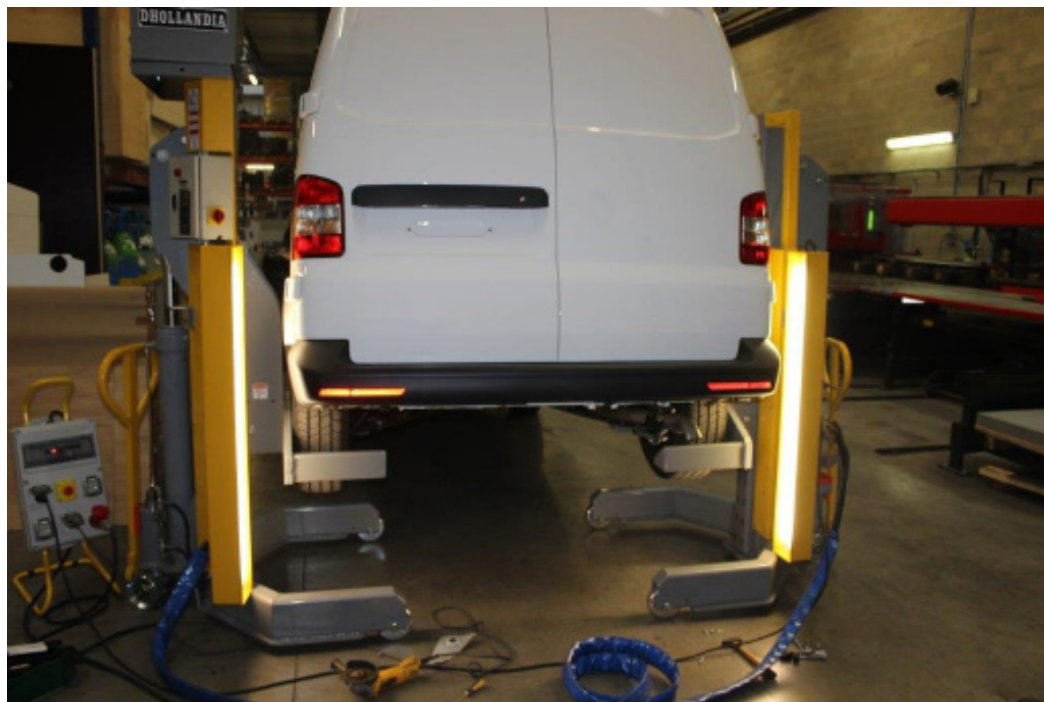
Zone dédiée et outillage spécifique destiné au montage des hayons éleveurs DHOLLANDIA.
